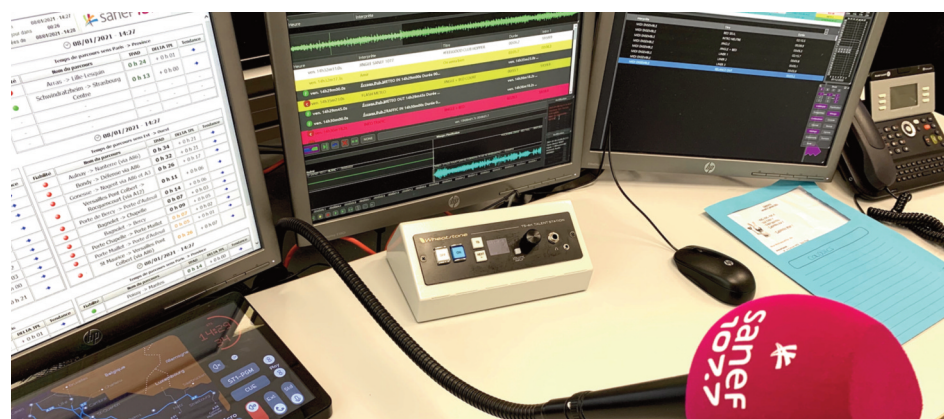
Dans un studio de diffusion, l'interface tactile ScreenBuilder et le pupitre de contrôle TS4. © Maxime Paillé - Mediameeting.
